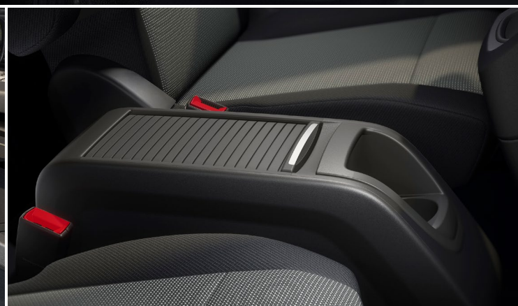
MODUCONSOLE: demontowana konsola środkowa z zamykanym dużym schowkiem
